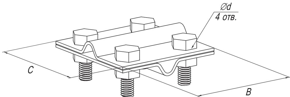
Предназначен для параллельного либо перпендикулярного соединения токоотвода  $\varnothing 6-10$  мм.
